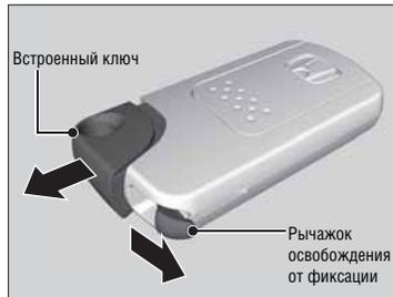
Встроенный ключ можно использовать для запирания и отпирания дверей в том случае, когда разрядился элемент питания карты системы доступа в автомобиль без ключа, и функция дистанционного отпирания и запирания дверей не работает.
