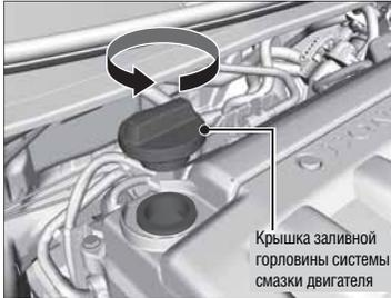
1. Отверните и снимите крышку заливной горловины системы смазки двигателя.
