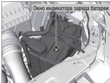
Ежемесячно проверяйте состояние аккумуляторной батареи. Определите степень заряда аккумуляторной батареи по ее индикатору, а также осмотрите выводы батареи, обращая внимание на образование коррозии и надежность фиксации клемм на полюсах АКБ.
