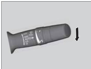
При перемещении рычага управления вниз в положение AUTO щетки стеклоочистителя выполнят один цикл, и стеклоочиститель переключится в автоматический режим работы.
