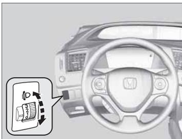
Вы можете отрегулировать угол наклона в вертикальной плоскости световых пучков ближнего света фар, когда выключатель зажигания находится в положении ON II (Зажигание включено)<sup>1</sup>.
