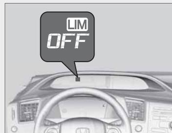
В случае возникновения проблемы в системе во время использования регулируемого ограничителя скорости движения, прозвучит звуковой сигнал, и включится индикатор **OFF**. При этом регулируемый ограничитель скорости движения выключится.
