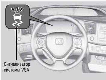
В случае активации системы VSA вы можете почувствовать, что двигатель не реагирует на нажатие педали акселератора. При этом вы можете услышать шум, издаваемый гидравлическими компонентами системы. Во время работы системы VSA мигает сигнализатор системы.
