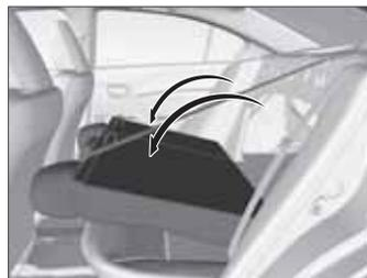
1. Снимите с направляющей петли ремень безопасности центрального посадочного места заднего сиденья.
