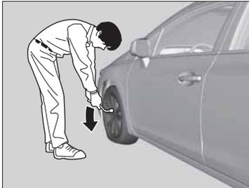
6. С помощью колесного ключа отверните колесные гайки на один оборот.
