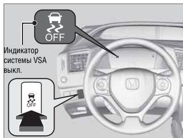
Выключатель системы динамической стабилизации расположен на панели управления с водительской стороны. Чтобы отключить или включить систему VSA, нажмите и удерживайте выключатель до тех пор, пока не раздастся звуковой сигнал.
