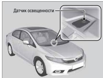
В состав системы климат-контроля входят датчик освещенности, датчик температуры и влажности воздуха. Не закрывайте датчики и не допускайте попадания на них жидкостей.
