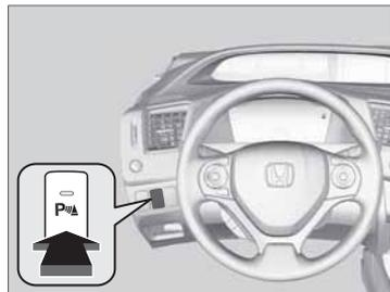
Когда выключатель зажигания находится в положении ON **II**, нажмите на выключатель системы помощи при парковке задним ходом, чтобы включить или выключить систему. При включении системы, загорается индикатор, встроенный в выключатель, и раздается звуковой сигнал.
