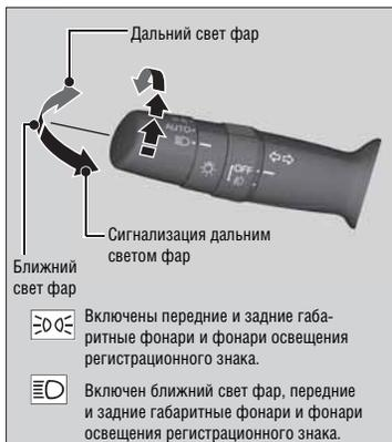
Повернув выключатель освещения, можно включить или выключить внешние световые приборы независимо от положения выключателя зажигания.<sup>1</sup>
