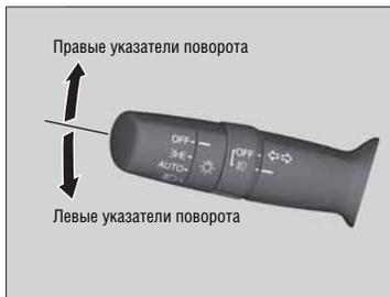
Указатели поворота можно включить, когда выключатель зажигания находится в положении ON II (Зажигание включено)<sup>1</sup>.
