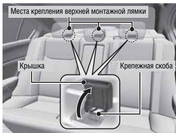
Точки крепления верхней монтажной лямки детского удерживающего устройства расположены за крайними посадочными местами заднего сиденья.\* Для обеспечения дополнительной фиксации детского удерживающего устройства, закрепленного с помощью ремня безопасности, вы можете воспользоваться верхней монтажной лямкой.
