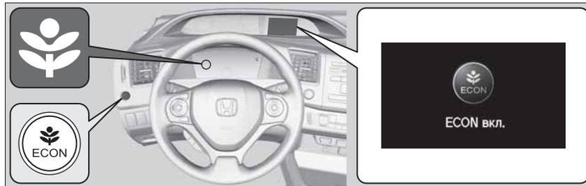
Кнопка ECON предназначена для включения и выключения экономичного режима ECON. Включение режима ECON помогает водителю повысить топливную экономичность путем изменения режима работы двигателя, коробки передач, системы кондиционирования воздуха и системы круиз-контроля.
