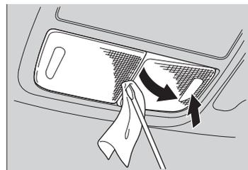
1. Нажмите на рассеиватель со стороны, противоположной той, где находится перегоревшая лампа.
