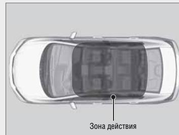
Вы можете запустить двигатель, когда карта системы доступа в автомобиль без ключа находится внутри автомобиля. Двигатель может работать, когда карта системы доступа в автомобиль без ключа находится вблизи двери или окна, даже если она находится снаружи автомобиля.
