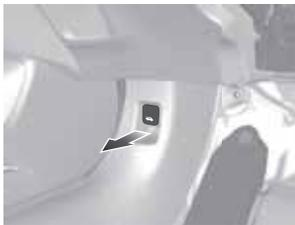
**2** Нажупайте рукой под капотом рычаг предохранительной защелки. Потяните рычаг вверх и поднимите капот.
