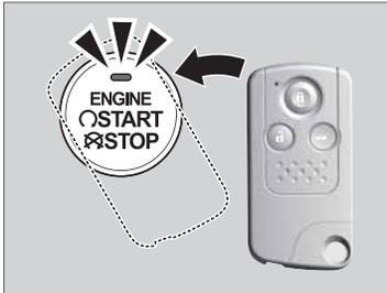
1. Когда мигает индикатор, дотроньтесь до кнопки ENGINE START/ STOP логотипом H, имеющимся на карте системы доступа в автомобиль без ключа. При этом кнопки на карте системы доступа в автомобиль без ключа должны быть обращены к вам.
