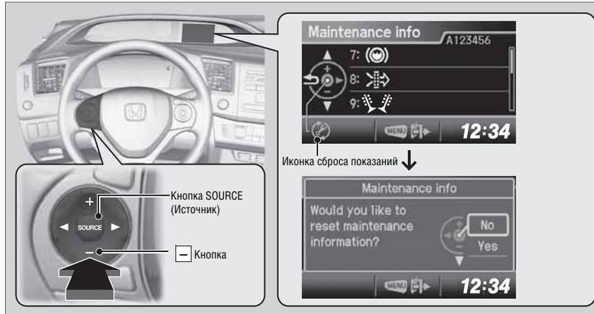
1. Поверните выключатель зажигания в положение ON (Зажигание включено)<sup>1</sup>.
