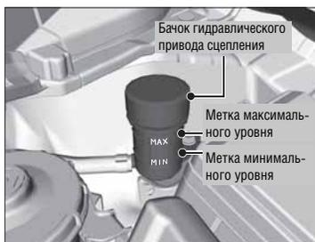
Бачок гидравлического привода сцепления
