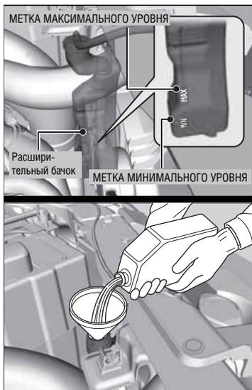
1. Проверьте уровень охлаждающей жидкости в расширительном бачке.
