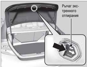
С целью обеспечения безопасности рычаг экстренного отпирания, расположенный внутри багажника, позволяет отпереть крышку багажника изнутри автомобиля.
