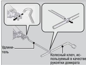
3. Поднимите автомобиль. Для этого вращайте рукоятку домкрата вместе с удлинителем до тех пор, пока колесо не оторвется от опорной поверхности.
