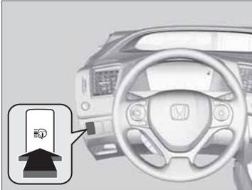
Для включения омывателей фар включите фары и нажмите на кнопку включения омывателей фар. Омыватели фар также включаются при первом включении омывателя ветрового стекла после переключения выключателя зажигания в положение ON **II** (Зажигание включено)<sup>1</sup>.
