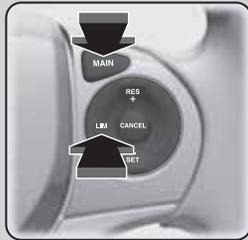
Если на дисплее отображается экран, не связанный с работой системы регулируемого ограничителя скорости движения, нажмите кнопку LIM для вывода на дисплей экрана регулируемого ограничителя скорости движения.
