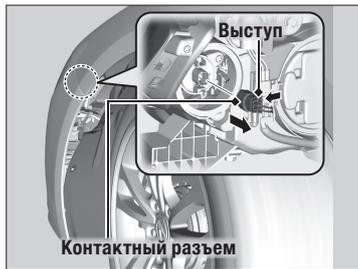
4. Нажмите на выступ, чтобы снять контактный разъем.
