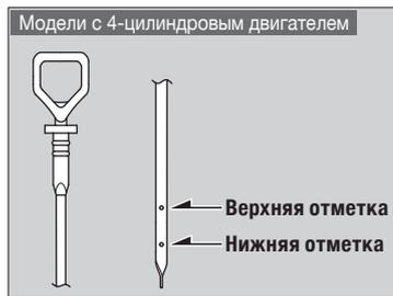
4. Снова выньте щуп и проверьте уровень масла по его следам на щупе. Он должен быть между верхней и нижней отметками на щупе. При необходимости долейте моторное масло.
