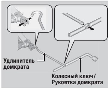
3. Проворачивая колесный ключ, поднимите автомобиль домкратом, пока поврежденное колесо полностью не поднимется над землей.
