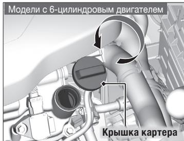
1. Открутите и снимите крышку масляного картера двигателя.
