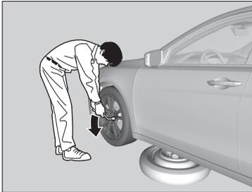
**6.** С помощью колесного ключа из комплекта инструментов открутите каждую гайку поврежденного колеса приблизительно на один оборот.
