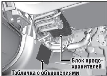
Расположение предохранителей показано на табличке на боковой панели. Определите требуемый предохранитель по его номеру и номеру на данной табличке.
