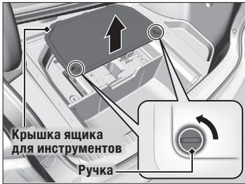
2. Поверните ручку против часовой стрелки, и снимите крышку ящика для инструментов.
