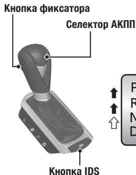
Нажмите на педаль тормоза и кнопку фиксатора, чтобы сдвинуть селектор АКПП из положения **P**.
