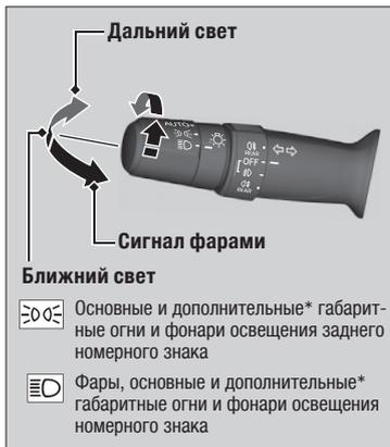
Вращайте верхнюю секцию переключателя, чтобы включить или выключить внешнее освещение независимо от режима питания систем автомобиля.
