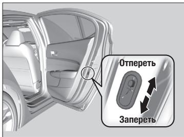
Передвиньте рычаг на боковой поверхности задних дверей в положение блокировки и закройте эти двери.
