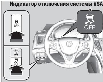
Выключатель системы VSA расположен на приборной панели со стороны водителя. Для включения или выключения системы VSA нажмите и удерживайте кнопку, пока не раздастся короткий звуковой сигнал.
