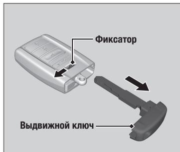
С помощью выдвижного ключа можно запереть/отпереть двери автомобиля, когда разряжен элемент питания пульта или электрический контур центрального замка вышел из строя.
