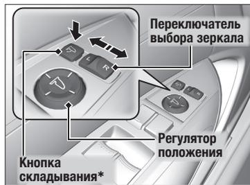
Чтобы отрегулировать положение наружных зеркал заднего вида, включите зажигание (режим питания: «ВКЛЮЧЕНО»).
