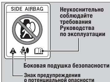
Таблички расположены в проемах передних дверей автомобиля.
