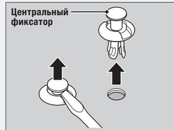
Вставьте фиксатор с поднятой головкой в отверстие, а потом нажмите на нее до конца, чтобы зафиксировать.
